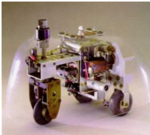
Tortuga de Grey Walter (bautizada como Machina Speculatrix), segunda generación
